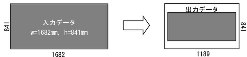
**例 3** : 横長の A0 (w=1189mm, h=841mm) データを定型用紙サイズにスケーリング変換して (縮小)、右回転
