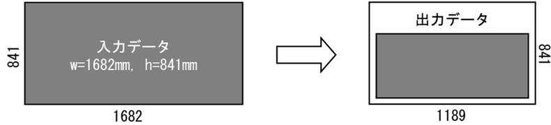
**例 2** : 横長の A0L (w=1682mm, h=841mm) データを定型用紙サイズにスケーリング変換
