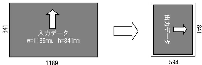
**例 4** : 横長の A0 (w=1189mm, h=841mm) データを定型用紙サイズにスケーリング変換 (縮小)
