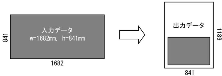
この例の場合には、入力データは横長で、出力サイズは縦用紙の指定になっているので用紙に収める為に、用紙の上方に余白が大きく出ています。出力時の向きを入力サイズの向きに合わせる場合には、オプションの設定によって用紙は入力データの向きに合わせて自動回転が可能です。(下図)
