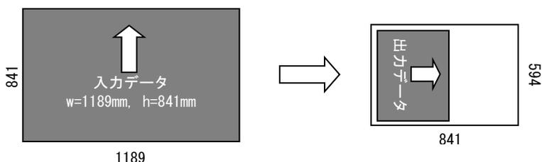
上の例は、出力後の用紙向き (90 度回転後) を入力データの向きと合わせたい時、オプションの指定によって入力データの向き (横図面 / 縦図面) は用紙方向に合わせて回転することが可能です。
